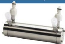
Typ 32J Ummantelte Probenküvette mit kleinem Volumen: Typ 32 mit Edelstahlmantel, der den Hauptkörper der Zelle umgibt, um die Zirkulation der Temperierflüssigkeiten zu ermöglichen. Auch mit HPLC-Anschlüssen erhältlich. Die Zelle hat einen eingebauten Temperaturanschluss, der es dem Temperatursensorsystem ermöglicht, die Temperatur in der Zelle automatisch zu messen.
