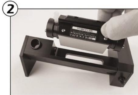
Platzieren Sie ein Polarimeter mit 2,5 mm Zelle in die Rudolph FillStation®
